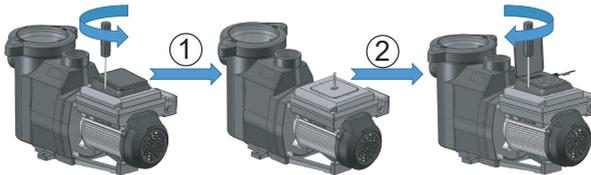
Após ter soltado o display, observe que na lateral tem uma entrada para colocação de um prensa cabos (acompanha na motobomba) passe o cabo de 4 vias pelo prensa cabo, faça a ligação elétrica seguindo a sequência fio preto IN1, fio branco IN2, fio amarelo IN3, fio vermelho +5V.
